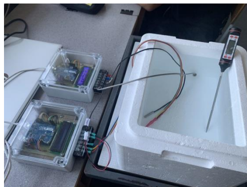
Obrázok 5 Meracia zostava merania teploty vody kontaktným spôsobom s referenčným teplomerom
